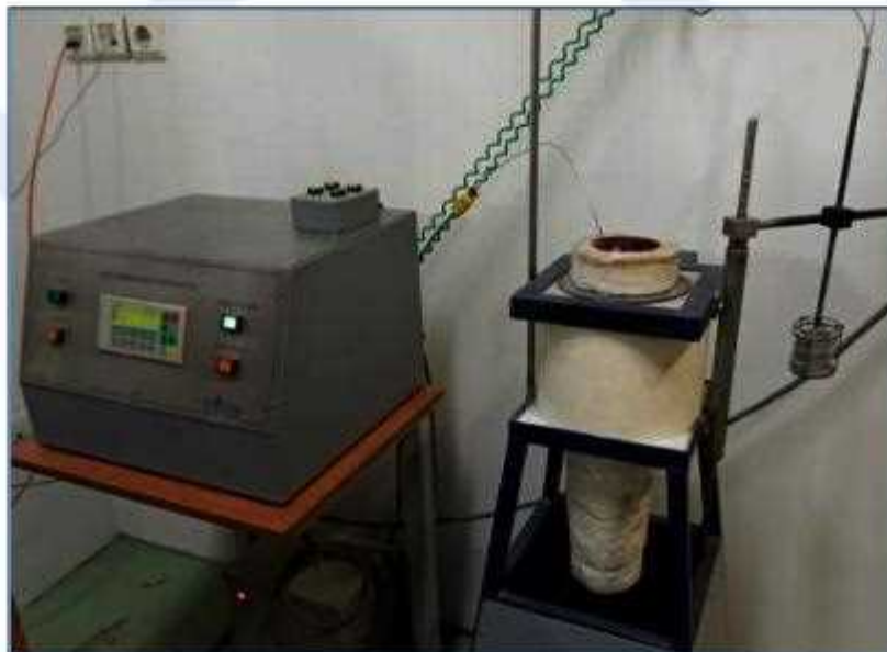
شکل ۵- دستگاه اندازه‌گیری قابلیت نسوختن مواد
